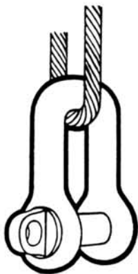
Piegamento della fune su raggio troppo piccolo (in questo caso la portata si riduce a circa il 50%)
